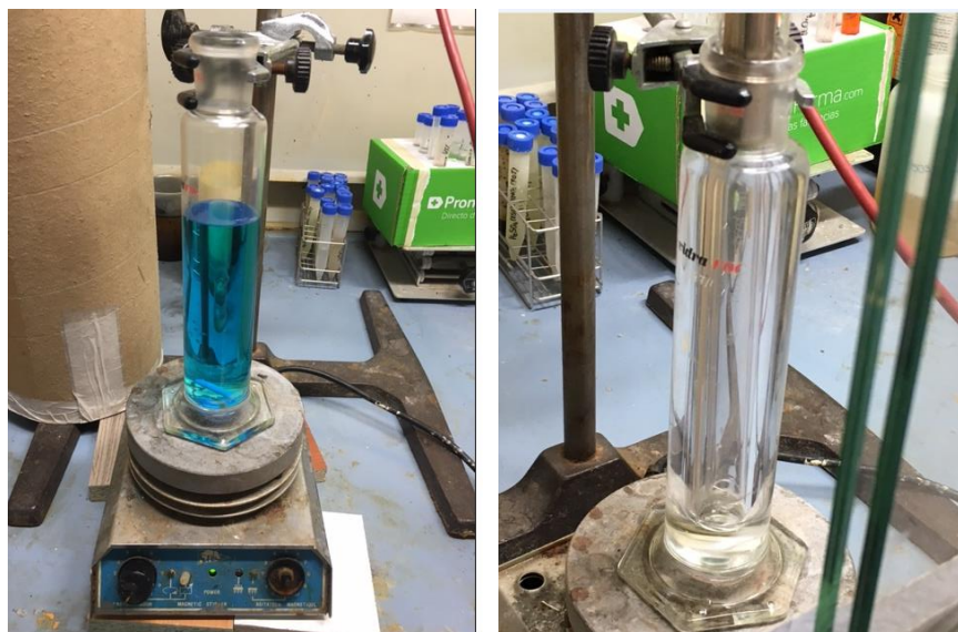
Imagen 29. Montaje Reactor de 206 mL con lámpara de 254 nm.
