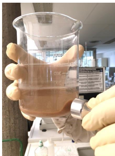
Imagen 16. Efecto magnético NPs \text{TiO}_2/\text{SiO}_2/\text{Fe}_3\text{O}_4 con imán en las paredes del vaso precipitados.
