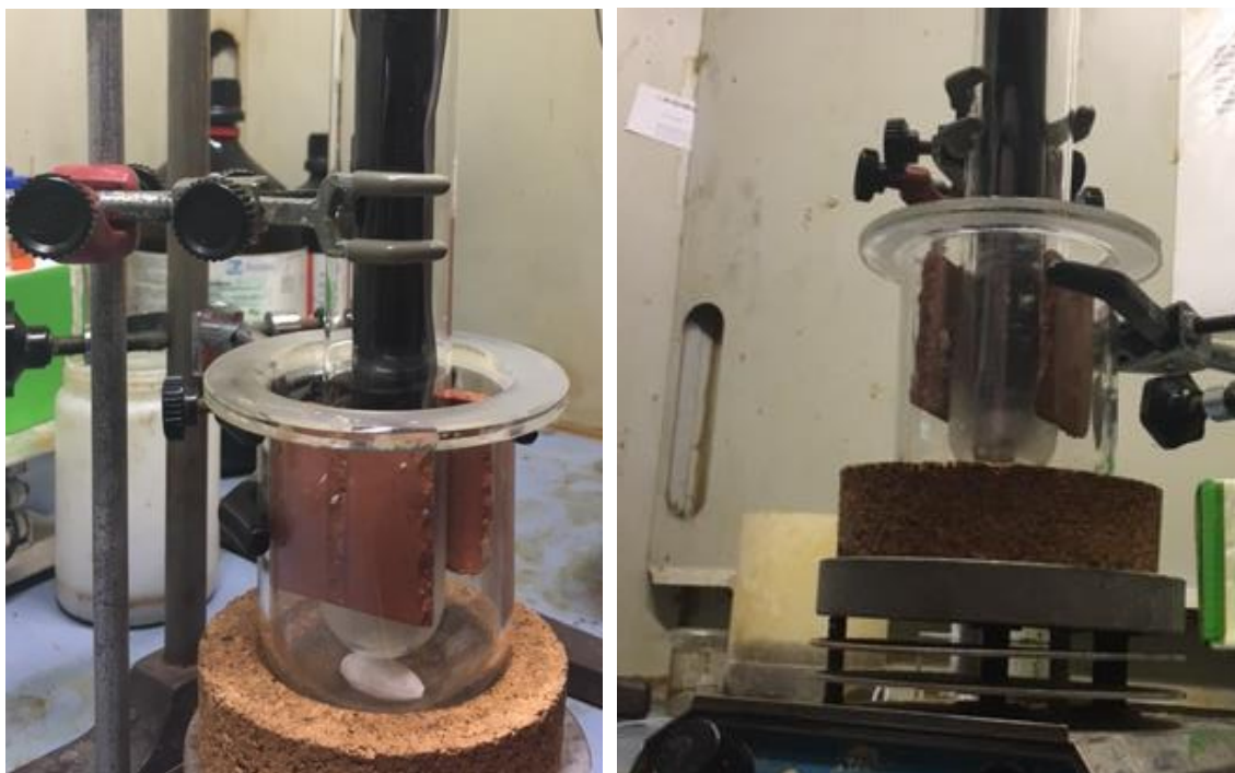
Imagen 23. Microrreactor con agitador magnético, placas microporosas de ladrillo y tubo fluorescente UV resguardado en otro tubo de vidrio.
