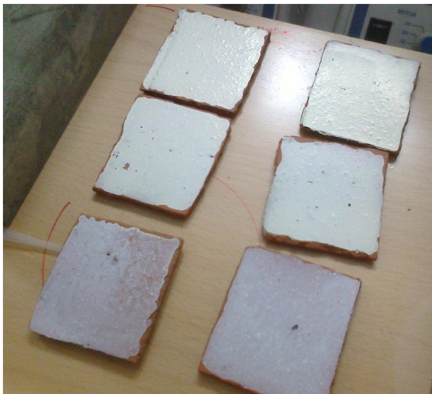
Imagen 25. Muestras después de haber perdido la mayor cantidad de agua. Serie de material de molienda. Muestras 4-6.
