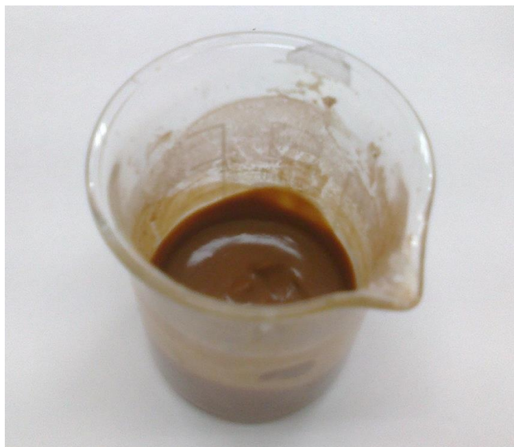
Imagen 12. Nanocompuesto obtenido del recubrimiento de nanopartículas de magnetita.
