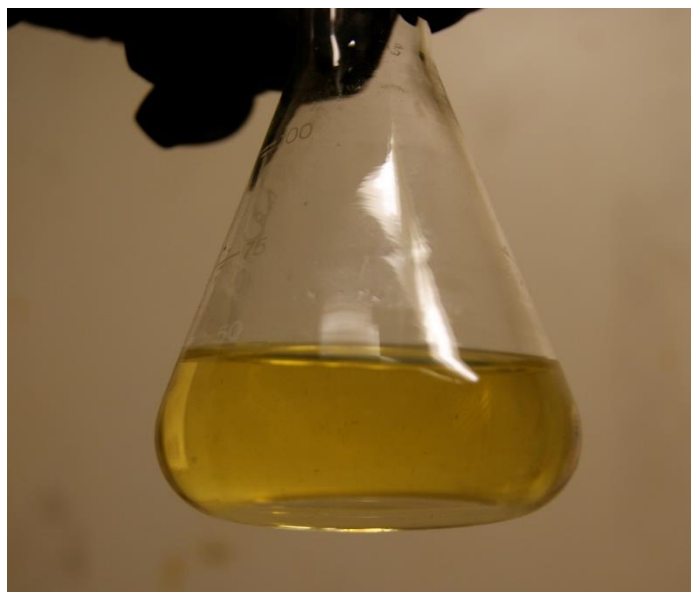
Imagen 7. Color amarillo, característico del plasmón electrónico de la superficie confinada de las nanopartículas de plata resultantes.
