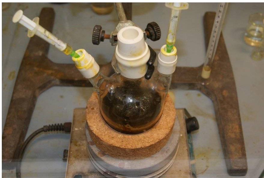
Imagen 1 – Reactor sellado y lleno de nitrógeno gas con el medio de reacción de síntesis. Por los extremos se adiciona las disoluciones ácidas de férrico y ferroso gota a gota.
