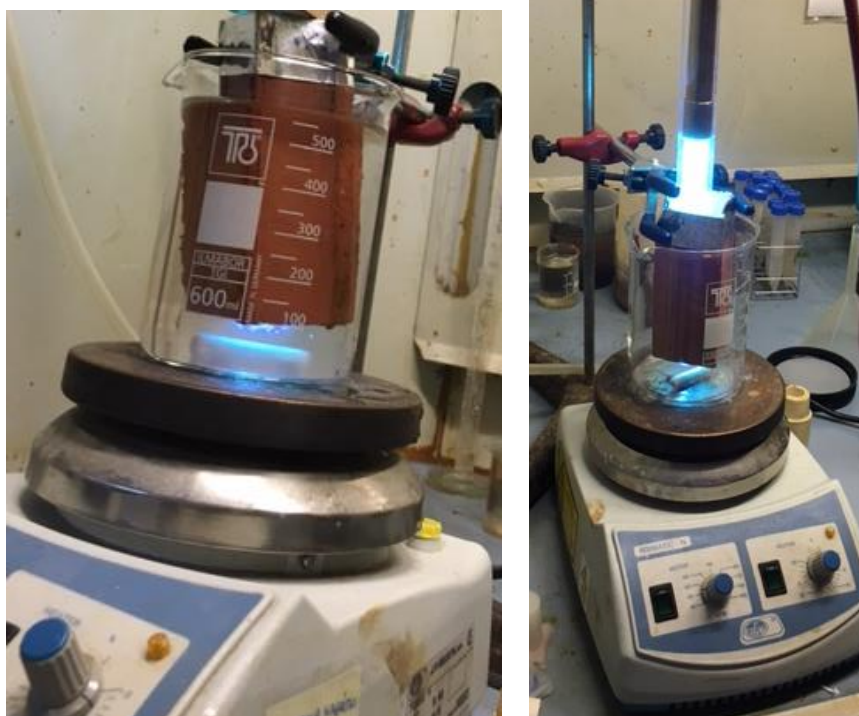
Imagen 22. Esquema del montaje experimental del microrreactor cerámico poroso.
