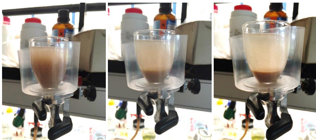
Imagen 17. Evolución-decantación magnética NPs \text{TiO}_2/\text{SiO}_2/\text{Fe}_3\text{O}_4 con imán y líquido sobrenadante, n-propanol (todavía con algo de turbidez por partículas dispersas).
