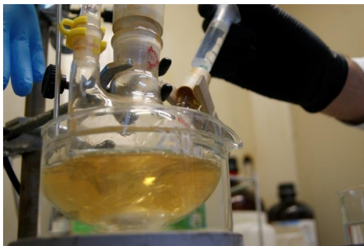
Imagen 4. Disolución PEG con sal ferrosa, adición de agua oxigenada.
