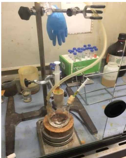
Imagen 14. Síntesis de magnetita ( \text{Fe}_3\text{O}_4 ) en atmósfera de \text{N}_2 a Tamb.
